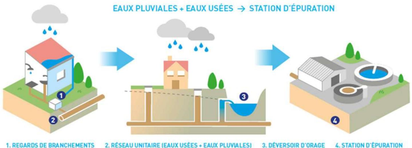
Lors du déploiement du réseau d'assainissement dans les années 60, il s'agissait de faire un « tout à l'égout » : un seul et même réseau unitaire est chargé de collecter et de transporter les eaux usées et les eaux pluviales jusqu'à une station d'épuration afin d'y être traitées.
